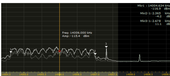
CIS 12 Signal, 12x120Bd PSK2, Pilotton bei 3300Hz Bandbreite 2.7 kHz
