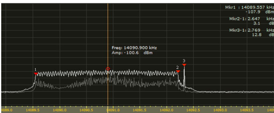
OFDM 60; 60 Töne, Tonabstand 44.4Hz, + Pilot Ton; Spektrum mit Perseus SDR; HB9CET
