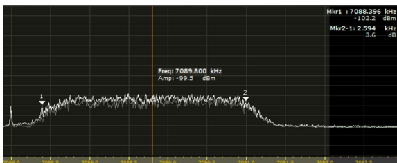
LINK11 SLEW auf 7089.8 kHz CF bzw 7088.0 USB PSK8 - Symbol Rate 2400Bd
