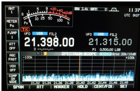
Fig. 3: Gedehntes Spektrum am 24.10. 2019, von 21.298 MHz bis 21.498 MHz. Die Anlage wurde kurz vor Mittag durch Fernsteuerung über das Internet abgeschaltet. Oberhalb von etwa 21.48 MHz sind noch Signale von einer PLC-Anlage in der Umgebung mit ausgeglichtem Amateurband erkennbar. Ref.-Level (Wert an oberer Kante) -50 dBm, 10 dB/Linie. Antennenfaktor AF_E = -11,5 dB/m. Bei Anlagenabschaltung tritt nur noch der Grundstörpegel auf, es ist die richtige Anlage!
