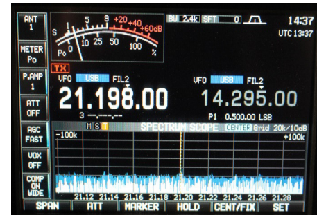
Fig. 5: Gedehntes Spektrum, von 21.098 MHz bis 21.298 MHz am Nachmittag des 15.01.2020 nach erfolgter Sanierung. Der Störpegel variiert nur noch ca. zwischen -95 dBm und -100 dBm. Ref.-Level (Wert an Oberkante) -50 dBm, 10 dB/Linie. Antennenfaktor AF_E = -11,5 dB/m. Max. Wert P_E = -95 dBm \rightarrow U = 12 dB \mu V \rightarrow E_{175} = U + AF_E = 0 dB \mu V/m.
