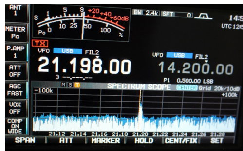
Fig. 2: Gedehtes Spektrum am 18.09.2019, kurz nach der Inbetriebnahme der Anlage im Abstand von 175 m, von 21.098 MHz bis 21.298 MHz, bei maximaler Störintensität.
