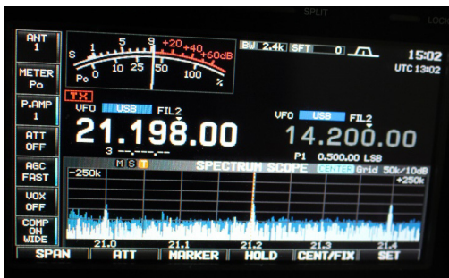
Fig. 1: Spektrum am 17.09.2019, kurz nach der Inbetriebnahme der Anlage im Abstand von 175 m, von 20.948 MHz bis 21.448 MHz bei mässiger Einstrahlung. Ref.-Level (Wert an oberer Kante) -50 dBm, 10dB/Linie. Antennenfaktor AF_E = -11,5 dB/m (für 5-El. Multiband Beam auf 15 m). Die für Solaredge-Optimizer-Anlagen typischen Harmonischen im 200-kHz-Raster sind auch empfangsmässig gut hörbar.
