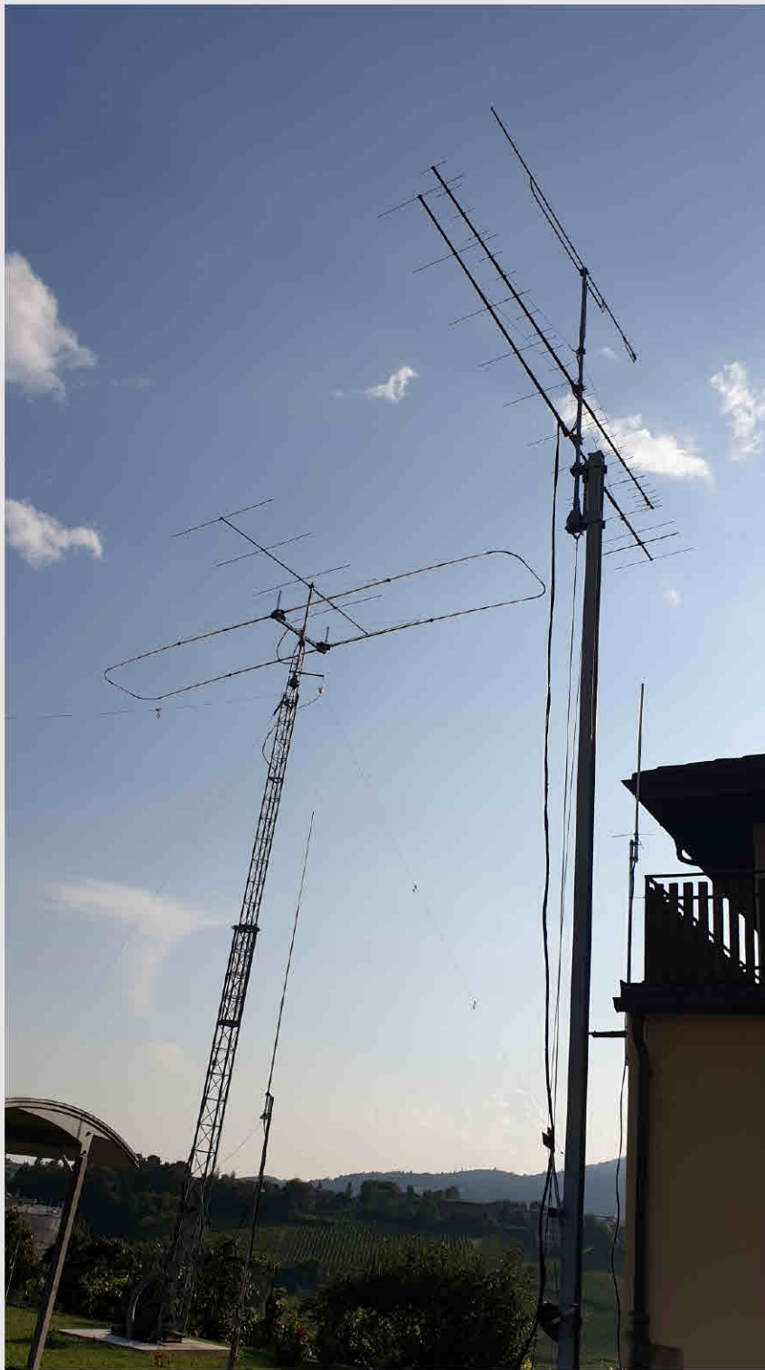
HB9HLM, QTH Boudry (NE), JN36KW – 12ele pour 144 MHz
