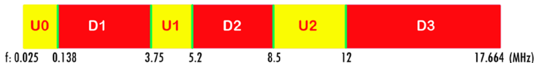
Schematische Darstellung des Bandplans 998ADE17 für VDSL 2 (Upstreams = Gelb, Downstreams = Rot)
