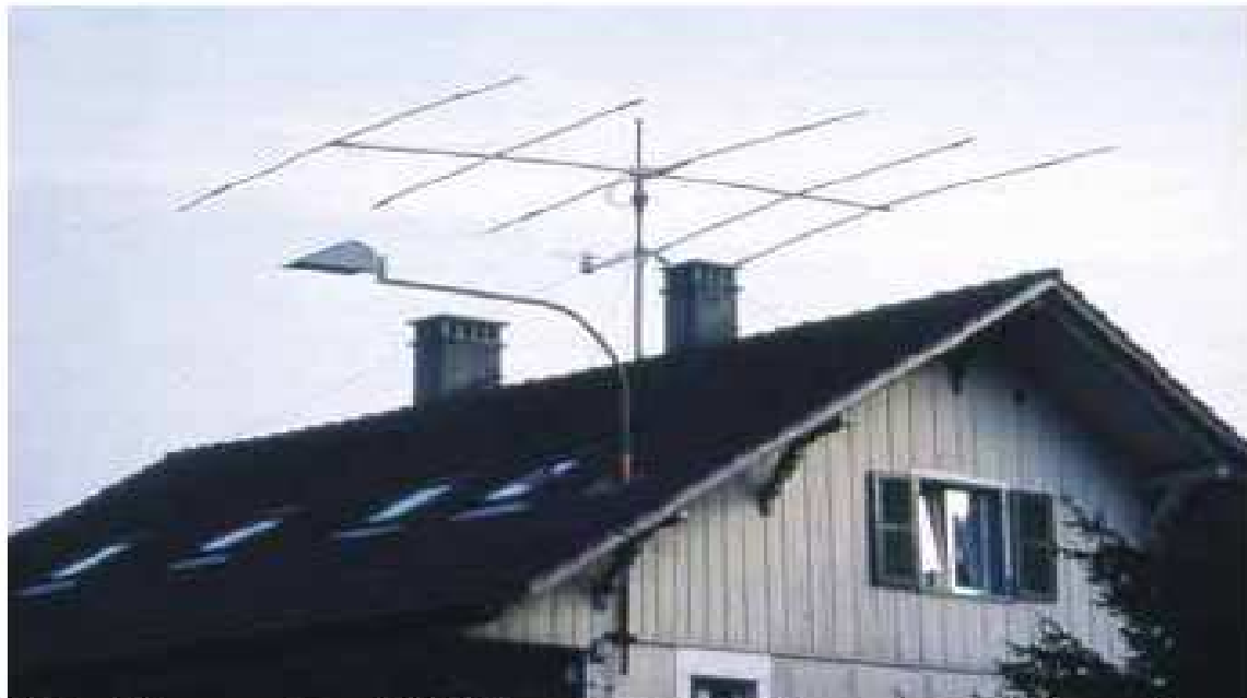
Auf Grund der grossen Typenvielfalt können Amateurfunkantennen sehr verschieden aussehen. Hier ist eine so genannte Yagi-Dachantenne abgebildet.
